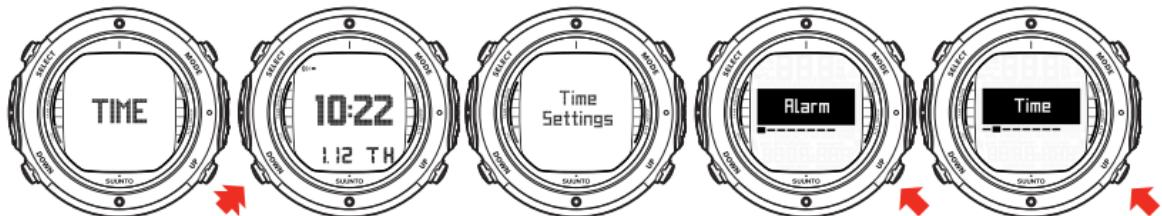
ИСПОЛЬЗУЙТЕ КНОПКИ UP И DOWN ДЛЯ ПЕРЕКЛЮЧЕНИЯ МЕЖДУ БУДИЛЬНИКОМ, ВРЕМЕНЕМ, ВТОРЫМ ПОЯСНЫМ ВРЕМЕНЕМ, ДАТОЙ, ЕДИНИЦАМИ ИЗМЕРЕНИЯ, КОНТРАСТОМ И ЗВУКОВЫМИ СИГНАЛАМИ.
