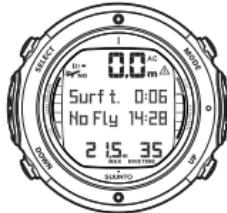
ВЫ НАХОДИТЕСЬ НА ПОВЕРХНОСТИ 6 МИНУТ ПОСЛЕ 35-МИНУТНОГО ПОГРУЖЕНИЯ. МАКСИМАЛЬНАЯ ГЛУБИНА СОСТАВИЛА 21,5 М. ТЕКУЩАЯ ГЛУБИНА РАВНА 0,0 М. СИМВОЛ САМОЛЕТА И ЗНАЧЕНИЕ ПАРАМЕТРА NO-FLY УКАЗЫВАЮТ НА ТО, ЧТО ВЫ НЕ ДОЛЖНЫ СОВЕРШАТЬ АВИАПЕРЕЛЕТЫ В ТЕЧЕНИЕ 14 ЧАСОВ И 28 МИНУТ. СИМВОЛ DIVER ATTENTION УКАЗЫВАЕТ НА ТО, ЧТО ВЫ ДОЛЖНЫ УВЕЛИЧИТЬ ПРОДОЛЖИТЕЛЬНОСТЬ ВАШЕГО ПЕРЕРЫВА НА ПОВЕРХНОСТИ.
