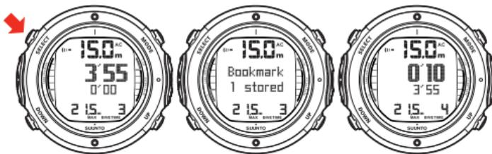
ПРИ НАЖАТИИ КНОПКИ SELECT ВО ВРЕМЯ ПОГРУЖЕНИЯ ПРОИСХОДИТ ЗАПИСЬ ЗАКЛАДКИ В ПАМЯТЬ ПРОФИЛЯ, СБРОС ВРЕМЕНИ ПОГРУЖЕНИЯ, И НИЖЕ ОТОБРАЖАЕТСЯ РАНЕЕ ИЗМЕРЕННЫЙ ИНТЕРВАЛ ВРЕМЕНИ.
