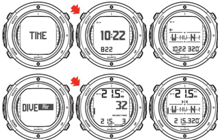
ПРИ ДОСТУПЕ ИЗ РЕЖИМА TIME ЗНАЧЕНИЯ ВРЕМЕНИ И АЗИМУТА ОТБРАЖАЮТСЯ В НИЖНЕЙ ЧАСТИ ЭКРАНА.
