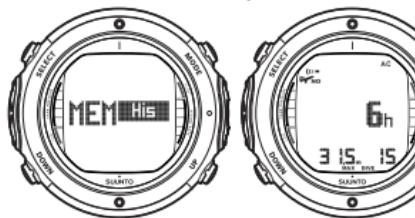
ДИСПЛЕЙ ИСТОРИИ ПОГРУЖЕНИЙ. ОБЩЕЕ ЧИСЛО ПОГРУЖЕНИЙ, ДЛИТЕЛЬНОСТЬ ПОГРУЖЕНИЙ В ЧАСАХ И МАКСИМАЛЬНАЯ ГЛУБИНА.
