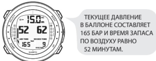
Изменение вашего потребления воздуха определяется по измерениям давления с постоянными интервалами в одну секунду за периоды длительностью 30–60 секунд. Повышение потребления воздуха вызывает более быстрое уменьшение времени, определяемого по запасу воздуха, в то время как снижение потребления медленно увеличивает это время. Это позволяет избежать чрезмерно оптимистических оценок времени, определяемого по остатку воздуха, в случае временного сокращения его потребления.
