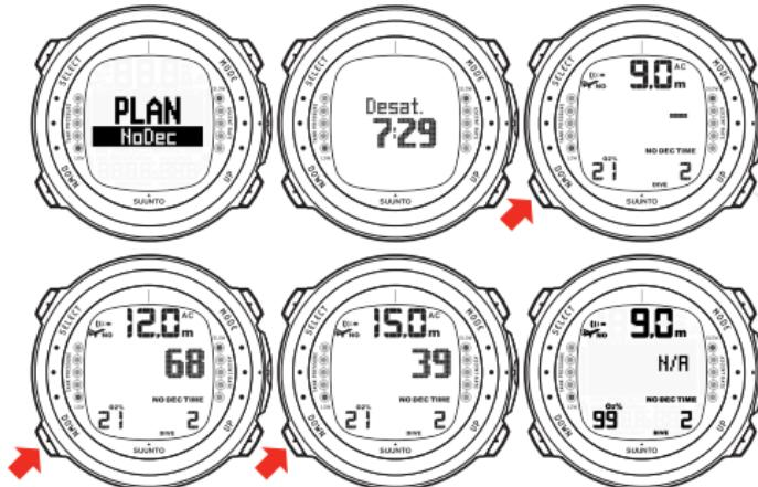
ПРИ ВХОДЕ В РЕЖИМ ПЛАНИРОВАНИЯ НА ДИСПЛЕЕ СНАЧАЛА КРАТКОВРЕМЕННО ОТОБРАЖАЕТСЯ ОСТАВШЕЕСЯ ВРЕМЯ РАССЫЩЕНИЯ ПЕРЕД ПЕРЕХОДОМ В РЕЖИМ ПЛАНИРОВАНИЯ. ИСПОЛЬЗУЙТЕ КНОПКИ UP И DOWN ДЛЯ ПРОКРУТКИ РАЗЛИЧНЫХ БЕЗДЕКОМПРЕССИОННЫХ ПРЕДЕЛОВ. БЕЗДЕКОМПРЕССИОННЫЕ ПРЕДЕЛЫ ПРОДОЛЖИТЕЛЬНОСТЬЮ СВЫШЕ 99 МИНУТ ОТОБРАЖАЮТСЯ СИМВОЛОМ «—».
