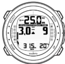
СТРЕЛКА, НАПРАВЛЕННАЯ ВВЕРХ, МИГАЮЩИЙ СИГНАЛ ВРЕМЕНИ ASC И СИГНАЛ ТРЕВОГИ ТРЕБУЮТ ВЫПОЛНИТЬ ПОДЪЕМ. МИНИМАЛЬНОЕ СУММАРНОЕ ВРЕМЯ ПОДЪЕМА, ВКЛЮЧАЯ ОСТАНОВКУ БЕЗОПАСНОСТИ, СОСТАВЛЯЕТ 9 МИНУТ. ПОТОЛOK НА ГЛУБИНЕ 3 M.
