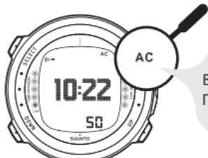
СИМВОЛ AC ОТОБРАЖАЕТСЯ В ПРАВОМ ВЕРХНЕМ УГЛУ ДИСПЛЕЯ ПРИ КОНТАКТЕ ПОДВОДНОГО КОМПЬЮТЕРА С ВОДОЙ. ЭТО ТАКЖЕ АКТИВИРУЕТ РЕЖИМ DIVE.
