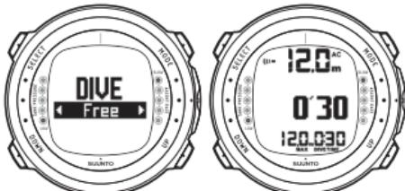
Отсчет времени фридайвинга завершается после возврата на поверхность (на глубине 0,5 м/ 1,6 фута).
