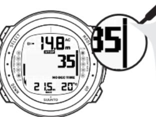
ВКЛЮЧЕННАЯ ПОДСВЕТКА, СИГНАЛ ТРЕВОГИ И МИГАНИЕ ПОЛОСКОВОГО ИНДИКАТОРА СКОРОСТИ ПОДЪЕМА УКАЗЫВАЮТ НА ТО, ЧТО СКОРОСТЬ ВАШЕГО ПОДЪЕМА ПРЕВЫШАЕТ 10 М/МИН. ВАМ ПРЕДПИСЫВАЕТСЯ ВЫПОЛНИТЬ ОБЯЗАТЕЛЬНУЮ ОСТАНОВКУ БЕЗОПАСНОСТИ ПРИ ДОСТИЖЕНИИ ГЛУБИНЫ 6 М.
