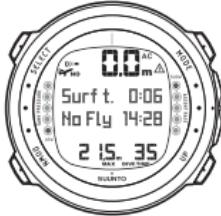
ВЫ НАХОДИТЕСЬ НА ПОВЕРХНОСТИ 6 МИНУТ ПОСЛЕ 35-МИНУТНОГО ПОГРУЖЕНИЯ. МАКСИМАЛЬНАЯ ГЛУБИНА СОСТАВИЛА 21,5 М. ТЕКУЩАЯ ГЛУБИНА РАВНА 0,0 М. СИМВОЛ САМОЛЕТА И ЗНАЧЕНИЕ ПАРАМЕТРА NO-FLY УКАЗЫВАЮТ НА ТО, ЧТО ВЫ НЕ ДОЛЖНЫ СОВЕРШАТЬ АВИАПЕРЕЛЕТЫ В ТЕЧЕНИЕ 14 ЧАСОВ И 28 МИНУТ. СИМВОЛ DIVER ATTENTION УКАЗЫВАЕТ НА ТО, ЧТО ВЫ ДОЛЖНЫ УВЕЛИЧИТЬ ПРОДОЛЖИТЕЛЬНОСТЬ ВАШЕГО ПЕРЕРЫВА НА ПОВЕРХНОСТИ.
