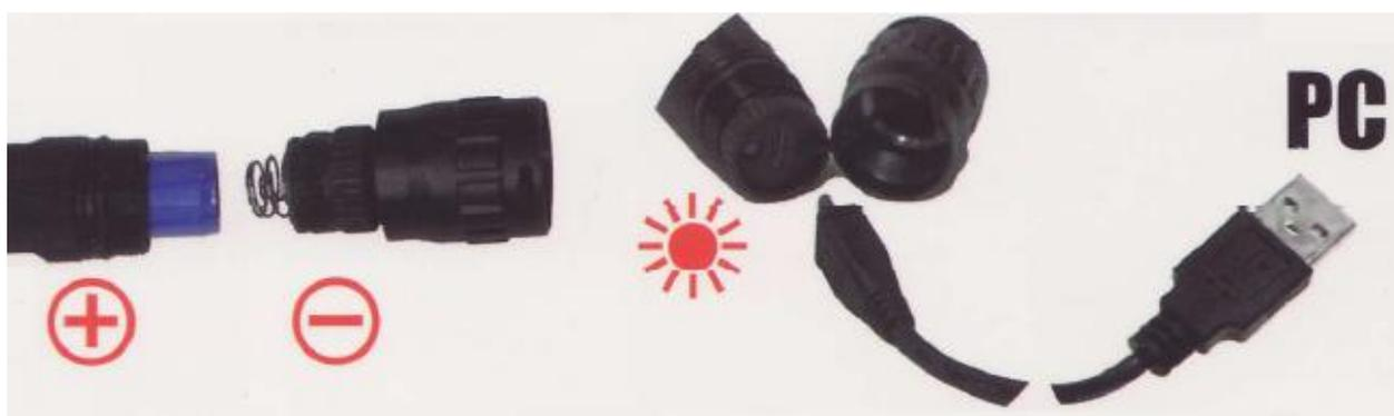
Для зарядки аккумулятора открутите крышку аккумуляторного отсека на задней части фонаря и подключите USB кабель к зарядному порту. Второй конец кабеля подключите к ПК или другому USB источнику питания.
