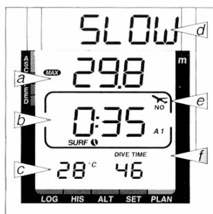
**Рисунок 3.17** Режим поверхности после погружения, Дисплей 1
