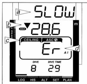
**Рисунок 4.5** Дисплей книги погружений в режиме нарушения, Дисплей 1
