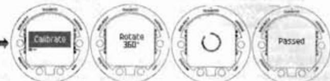
Если калибровка проходит неудачно несколько раз подряд, возможно, Вы находитесь в месте сильных магнитных полей, таких, как от больших металлических предметов, линий электропередач или электроприборов. Переидите в другое место и попробуйте провести калибровку еще раз. Если процесс калибровки снова не пройдет удачно, обратитесь в сервис-центр Suunto.
