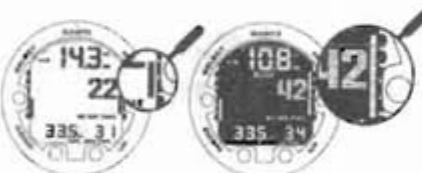
Активированная подсветка, звуковой сигнал и мигающая графическая диаграмма, отображающая скорость всплытия, указывают на то, что Вы всплываете быстрее, чем 10 м/мин. Вам следует произнести обязательную остановку безопасности, когда Вы достигнете глубины 6 метров.
