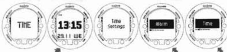
Используйте кнопки up и down, чтобы переключаться между будильником, временем, датой, единицами измерения, подсветкой и звуковыми сигналами
