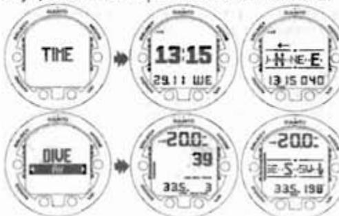
Если переход в режим компаса осуществлен из режима TIME (времени), в нижней части дисплея отображаются время и направление.
