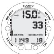
DOWN BUTTON TOGGLES BETWEEN MAXIMUM DEPTH, CURRENT TIME AND TANK PRESSURE.
