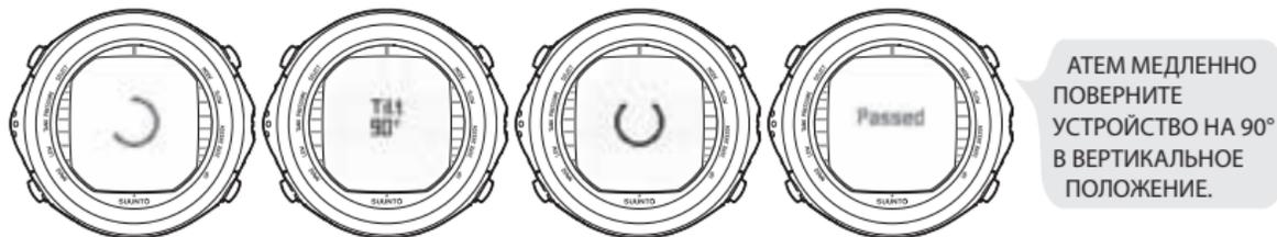
Повторные нарушения калибровки могут свидетельствовать о том, что вы находитесь вблизи от источников сильного магнитного поля, таких как крупные металлические предметы, линии электропитания или электрические приборы. После перемещения в другое место попробуйте выполнить калибровку компаса еще раз. Если калибровка по-прежнему не выполняется, свяжитесь с авторизованным сервисным центром компании Suunto.
