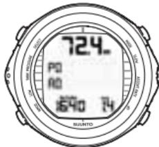
При установке режима MIXED подводный компьютер Suunto D9tx дополнительно отображает альтернативный дисплей:
