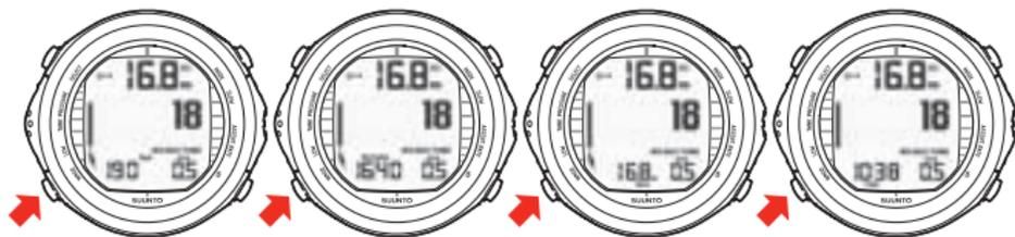
КНОПКА DOWN ПООЧЕРЕДНО ОТОБРАЖАЕТ  $O_2$ , МАКСИМАЛЬНУЮ ГЛУБИНУ ТЕКУЩЕЕ ВРЕМЯ И ДАВЛЕНИЕ В БАЛЛОНЕ.
