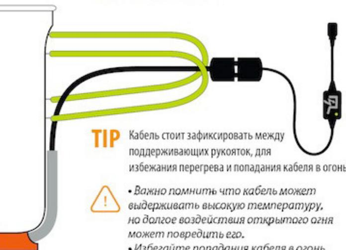
**TIP** Кабель стоит зафиксировать между поддерживающими рукояток, для избежания перегрева и попадания кабеля в огонь.
