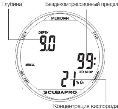
При задании времени пребывания на поверхности или по окончании интервала релаксации значение глубины на индикаторе планировщика начинает мигать. Глубина задается при помощи кнопок + и – с шагом 3 м / 10 футов.
