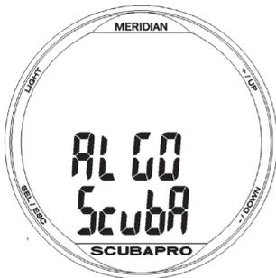
При нажатии кнопки ВЫБОР/ОТМЕНА в данном меню начинает мигать поле режима. При помощи кнопок +/ВВЕРХ и -/ВНИЗ производится переключение между режимами АКВАЛАНГ (SCUBA), ГЛУБИНОМЕР (GAUGE) и АПНОЭ (APNEA). Сохранение выбранного режима производится повторным нажатием клавиши ВЫБОР/ОТМЕНА.
