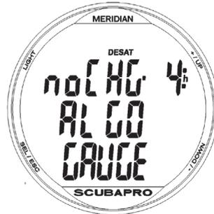
Переключение из режима АКВАЛАНГ в режим ГЛУБИНОМЕР или АПНОЭ разрешается только по окончании интервала насыщения.
