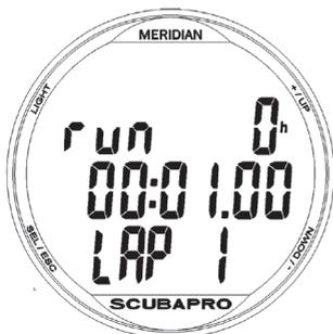
При нажатии кнопки +/ВВЕРХ секундомер начинает отсчитывать время; на индикаторе отображается RUN. Для остановки секундомера нажмите кнопку
