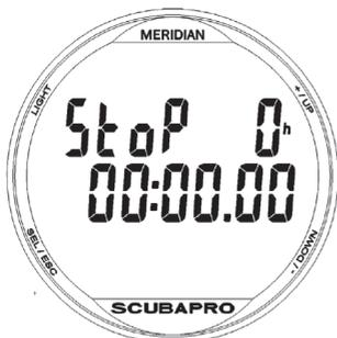
В первой строке индикатора отображается состояние секундомера: остановлен (STOP), запущен (RUN) или промежуточный результат (LAP). Внешний вид индикатора при первоначальном включении режима секундомера показан выше.
