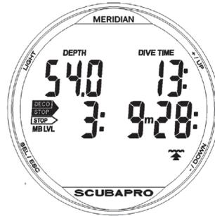
В нижней строке отображается дополнительная информация о погружении. При **последовательных нажатиях** кнопки +/- ВВЕРХ в ней отображаются следующие значения:
