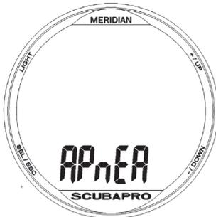
В приборе Meridian предусмотрен усовершенствованный режим АПНОЭ. Его основными отличиями являются увеличенная частота измерений по сравнению с режимом АКВАЛАНГ и специализированные сигналы тревоги, специально предназначенные для погружений с задержкой дыхания.
