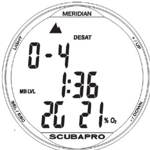
При нахождении в режиме АКВАЛАНГ после погружения **нажатие** кнопки ВЫБОР/ОТМЕНА позволяет вызвать группу меню, связанных с погружениями: время на поверхности, настройка газовой смеси,
