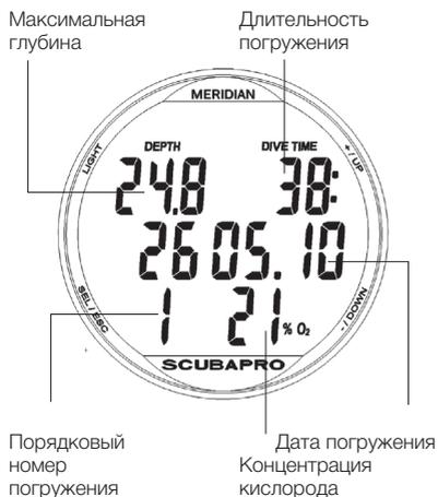
При погружениях в режиме ГЛУБИНОМЕР (GAUGE) или АПНОЭ (APNEA) в нижней строке главной страницы отображается соответственно GA или AP вместо содержания кислорода.
