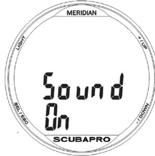
При нажатии кнопки ВЫБОР/ОТМЕНА начинает мигать слово ON в нижней части индикатора. Нажатием кнопки +/ВВЕРХ или -/ВНИЗ производится выключение (OFF) или включение (ON) предупредительных сигналов и звуков при нажатии кнопок. Функция отключения звука защищена кодом.
