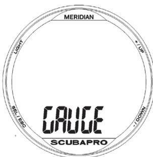
При работе в режиме ГЛУБИНОМЕР прибор Meridian контролирует только глубину, время и температуру, но не проводит расчетов декомпрессии. Переключение в режим ГЛУБИНОМЕР возможно только по
