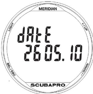
При нажатии кнопки ВЫБОР/ОТМЕНА для настройки даты начинает мигать первая группа цифр (день при 24-часовой индикации или месяц при 12-часовой индикации). Ее изменение производится кнопками +/ВВЕРХ и -/ВНИЗ. При нажатии кнопки ВЫБОР/ОТМЕНА установленное
