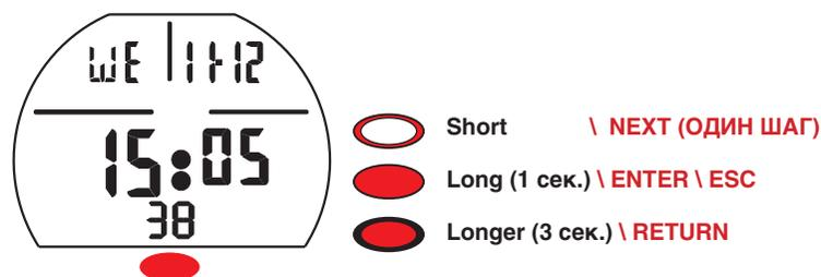
**Short** (white button) при кратковременном нажатии кнопка используется для прокрутки различных меню и установки настроек в порядке возрастания. При длительном нажатии **Long (1 сек.)** (red button) кнопка используется для входа в различные меню, а также для подтверждения. При ещё более длительном нажатии **Longer (3 сек.)** (red button with black outline) Вы вернетесь в предыдущее меню.
