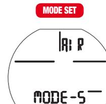
Функция **MODE-S** позволяет Вам выбрать предпочитаемый режим погружения. Для входа в режим **MODE-S** нажмите **Long** . Первая строка покажет слово SET и отобразит текущий установленный режим (мерцающий).
