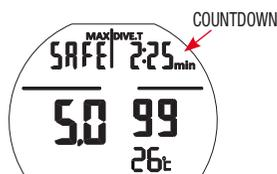
Остановка будет обозначена на дисплее значком SAFE. В этом случае четко отображается продолжительность остановки с обратным отсчетом минут и секунд. Остановка безопасности не является обязательной, но настоятельно рекомендуется, например, в случае многократно превышаемой максимальной скорости всплытия. Во избежание проблем с безопасностью, Cressi рекомендует Вам всегда выполнять эту остановку.
