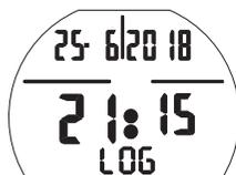
Первая строка отображает день, месяц и год погружения. Центральная строка показывает время начала погружения. Для погружений в режимах NITROX, FREE или GAGE отобразится соответствующий значок.
